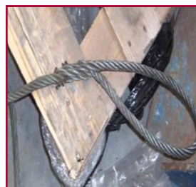
Eslinga de cable con ojal trenzado
